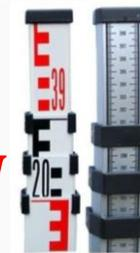
$$\text{Trigonométrico: } Dn = dh \times \text{tg} \alpha + h - FM$$
